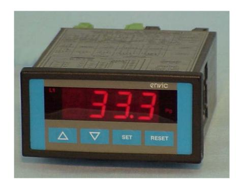
Intelligente Prozeßanzeige für alle Meßaufgaben 2 frei programmierbare analoge Eingänge Skalierbare Anzeige der Meßwerte Differenz-, Mittelwert-, Min / Max-Anzeige 2 oder 4 einstellbare Alarmgrenzen, 2 Relais-Ausgänge RS-232 und RS-485-Schnittstelle optional 96 x 48 x 120 mm Einbau-Gehäuse Stromversorgung 230 V 50 Hz oder 24 VDC Passwort-Schutz
