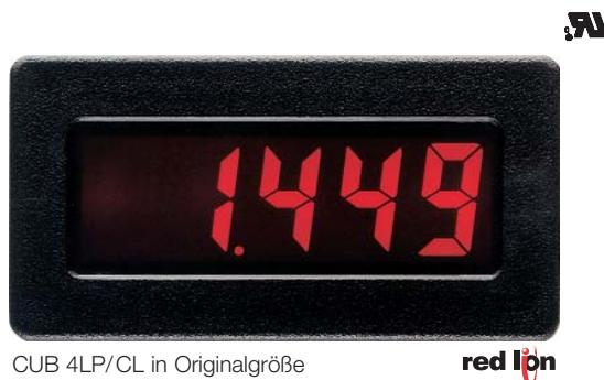
Der CUB4LP und der CUB4CL sind 3 1/2-stellige Prozess-Anzeigen mit Nullpunktgleichung und Bereichskalierung. Der Eingangsbereich ist zwischen 4 - 20 mA und 10 - 50 mA wählbar. Der CUB4LP bezieht seine Versorgung aus dem Eingangssignal und ist somit völlig netz-unabhängig. Der CUB4CL benötigt für seine hintergrundbeleuchtete LCD-Anzeige eine externe Versorgung. Dann leuchten die LCD-Ziffern intensiv rot oder grün.
