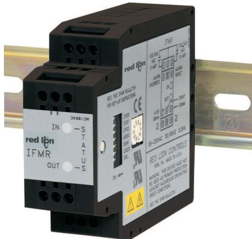
Der Drehzahlwächter IFMR verarbeitet eine Eingangsfrequenz von 0,1 Hz bis 25 kHz und schaltet ein Relais bei Über- oder Unterschreitung einer Sollfrequenz oder bei Stillstand. Mit einem 7-poligen DIP-Schalter, einem BCD-Rundschalter, einem Taster und 2 LED's lässt sich das Gerät leicht programmieren und überwachen. Er wird einfach auf die Hut- oder C-Schiene geschnappt.
