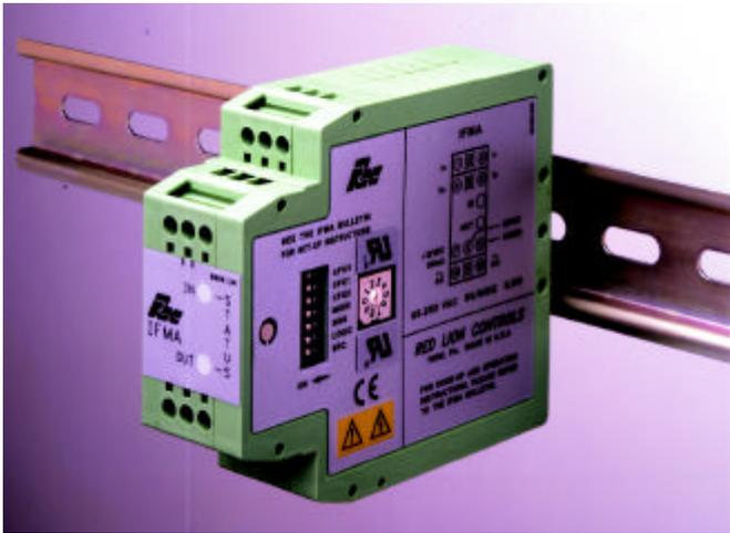
Der Frequenz-Analogwandler IFMA verarbeitet eine Eingangsfrequenz von 0 - 1 Hz bis 0 - 25 kHz und wandelt sie in ein analoges Signal um. Mit einem 7-poligen DIP-Schalter, einem BCD-Rundscharter, einem Taster und 2 LED's läßt sich das Gerät leicht programmieren und überwachen. Er wird einfach auf die Hut- oder C-Schiene geschnappt.
