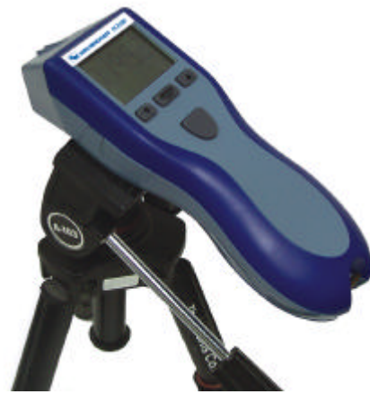
Montage des Laser-Tachometers auf einem Stativ
