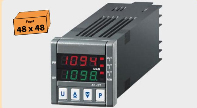
Selbstoptimierender, mikroprozessorgesteuerter Digitalregler mit 2-, 3-Punkt oder PID-Regelverhalten, 3-Punkt-Schritt-Regelverhalten und einstellbarem Sollwertgradienten (Rampenfunktion)
